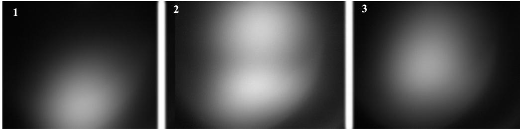
Figura 3.8: *Effetti delle tre configurazioni di optical pumping sulla nuvola.* Le immagini in fluorescenza sono ottenute tenendo la potenza dei fasci costante a 20.4 mW. Nel (1) un singolo fascio per 100  $\mu s$ , nel (2) entrambi contemporaneamente per 50  $\mu s$  e nel (3) un primo fascio per 50  $\mu s$  e subito dopo un altro per 50  $\mu s$ . Le aree vanno interpretate come stati di impulso.
