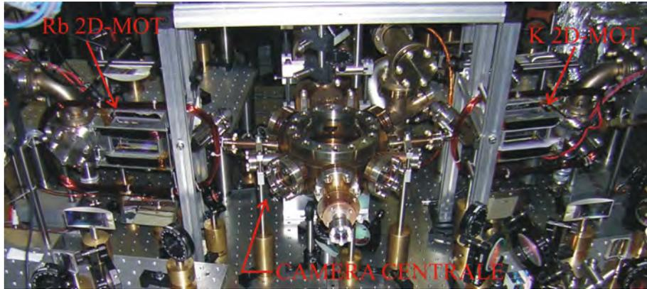
Figura 3.1: Immagine fotografica delle tre camere che costituiscono l'apparato da vuoto del nostro esperimento. Sulla sinistra la 2D-MOT di  $^{87}\text{Rb}$ , sulla destra la 2D-MOT di  $^{39}\text{K}$  e al centro la camera che ospita la 3D-MOT mista  $^{87}\text{Rb}$ - $^{39}\text{K}$  e la millitrappola.
